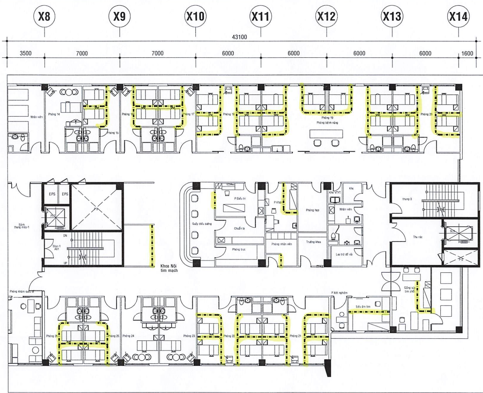
MẶT BẰNG RÈM CHE LẦU 7 - KHU A
